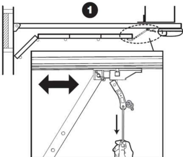
2. Avant de remettre le moteur en route, bouger manuellement la porte de garage jusqu'à que le chariot de guidage soit remis en prise.
