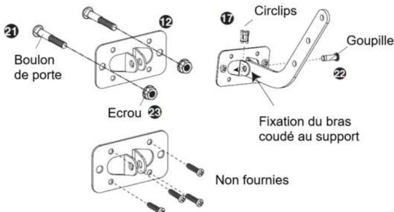
4. Fixer le bras coudé (14) de la porte au bras droit (15) avec les écrous et boulons.
